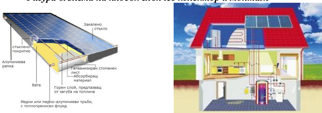
Фигура 8. Схема на плосък слънчев колектор и монтаж
