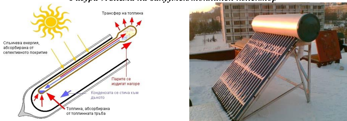
Фигура 9. Схема на вакуумен/топлинен колектор
