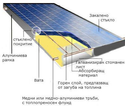
Фигура 12.Схема на плосък слънчев колектор и монтаж
